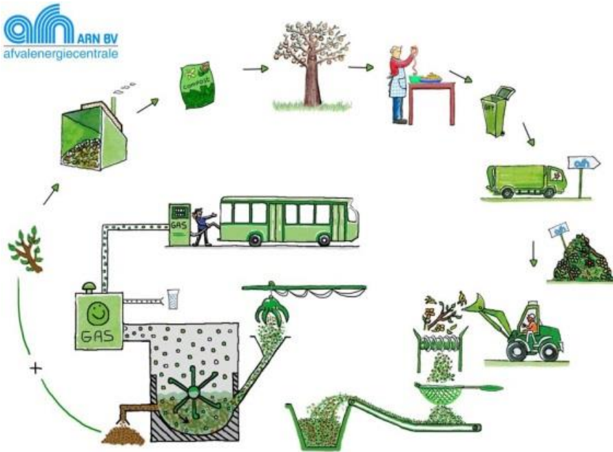
Schematische weergave van GFT vergisting. Bron: ARN afvalenergiecentrale
