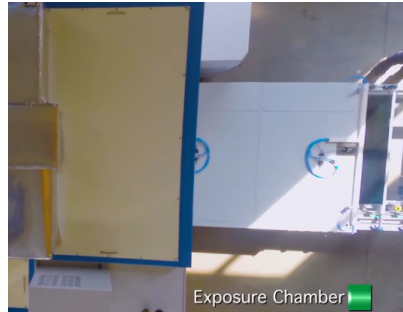
Stap 2: Paneel op rolband plaatsen en belichten in laserkamer, zodat hechting minder sterk wordt
